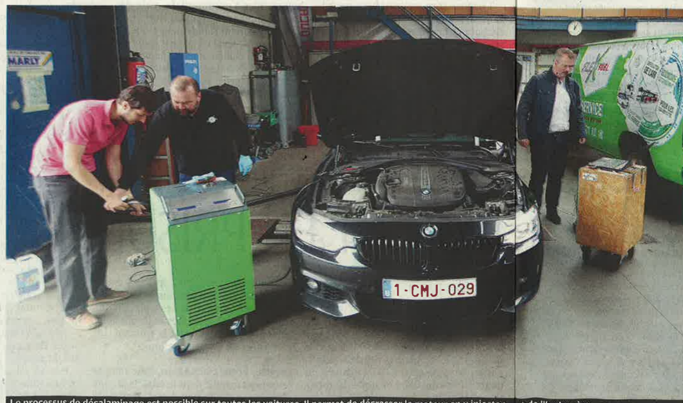
Le processus de décalaminage est possible sur toutes les voitures. Il permet de dégraisser le moteur en y injectant de l'hydrogène. © DEMOULIN
